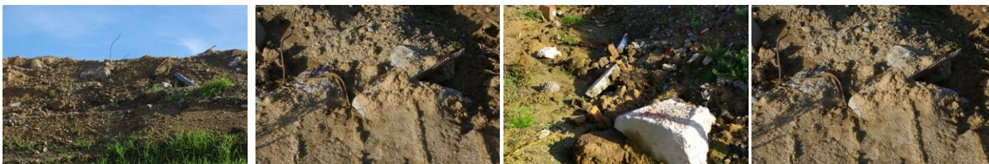
Bei einer Ortseinsicht am 29.09.14 boten sich dann u.a. folgende Verhältnisse mit gemischtem Bauschutt, ungebrochenem armiertem Betonabbruch (Plastikfolien, Holz- und Metallteilen, u.a. ein Beton-Zaunpfosten-Fundament mit abgebrochenem Metall-Zaunpfosten).
